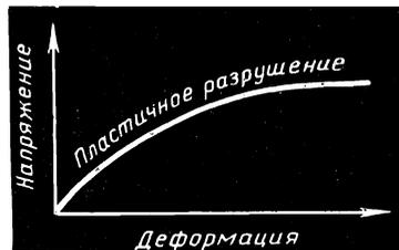
*Зависимость «напряжение—деформация». При сравнительно небольших нагрузках на линейном участке кривой, вплоть до предела текучести материал еще можно считать упругим. При дальнейшем увеличении нагрузки образуются остаточные, пластические деформации. В конце концов материал разрушается (средний и нижний рисунки). Когда разрушение наступает при сравнительно малых остаточных деформациях, говорят, что вещество хрупкое. Экспериментально установлено, что большинство горных пород разрушается хрупко*
